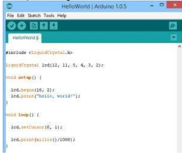
Şekil 3. Arduino ile 2×16 LCD Ekranı Yazı Yazdırma
