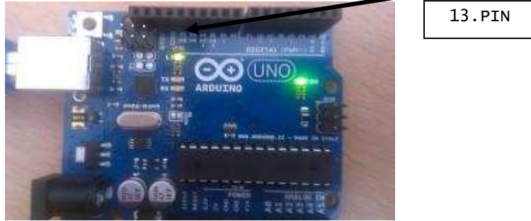
Şekil 20. Led Yak-Söndür Uygulaması
